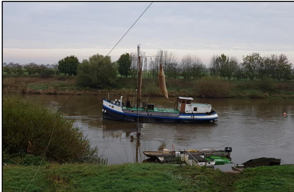
Abbildung 5: Aalschokker an der Fangstelle Drakenburg. Die Hamennetze werden beim Fang an beiden Seiten des Schokkers zu Wasser gelassen und stehen beim Fang geöffnet in der Strömung. Im Vordergrund befindet sich der Steg mit dem Arbeitsboot, mit dem der Schokker angefahren wird, sowie die GFK-Kisten (grün), in denen gefangene Aale in der Weser gehältert werden. Quelle: LAVES.
