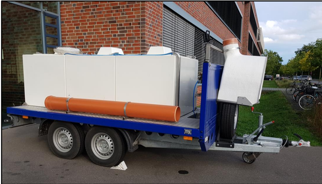
Abbildung 11: Im Rahmen des Projektes wurde ein Fischtransportanhänger für kürzere Transporte oder den Transport kleinerer Mengen Blankaale beschafft. Das Bild zeigt den Anhänger im Einsatz vor dem Gebäude der tierärztlichen Hochschule Hannover. Quelle: LAVES.
