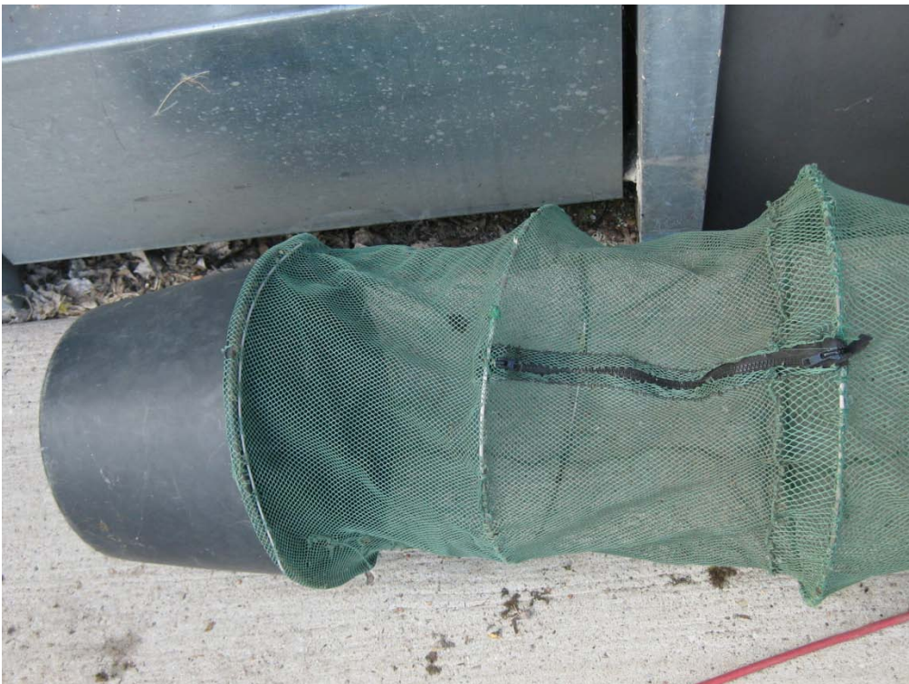
Abbildung 21: Netzreuse mit Eimer am Ende zur Reduktion von Turbulenzen und Reißverschluss für die Leerung und Reinigung (Foto: W. Schmalz)
