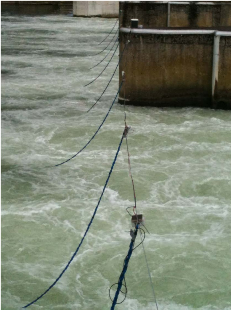
Abbildung 41: Stationäre Unterwasser-Antenne zur Detektion besonderer Fische im Turbinenauslauf einer Wasserkraftanlage (Foto: Profish Technology)
