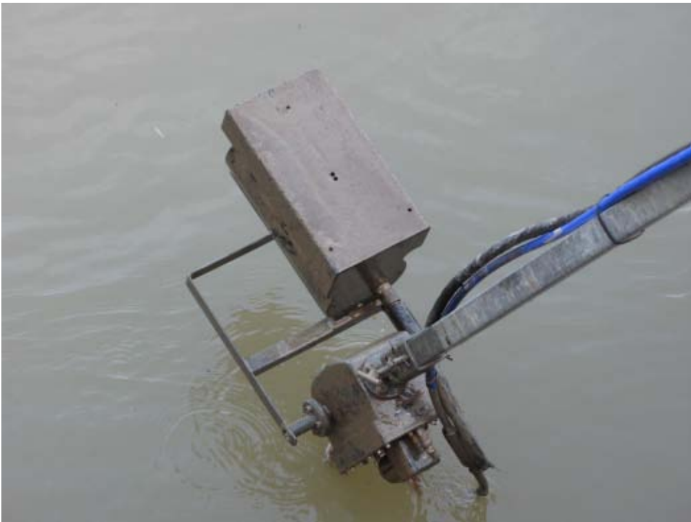
Abbildung 29: DIDSON montiert auf Schwenk- und Neigekopf im Feldeinsatz (Foto: M. Schmidt)
