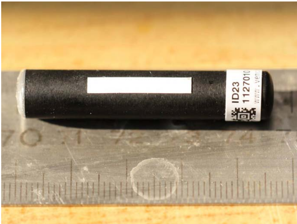
Abbildung 42: Acoustic-Tag, V9-Coded-Tag der Firma Vemco (Foto: R. Roy)
