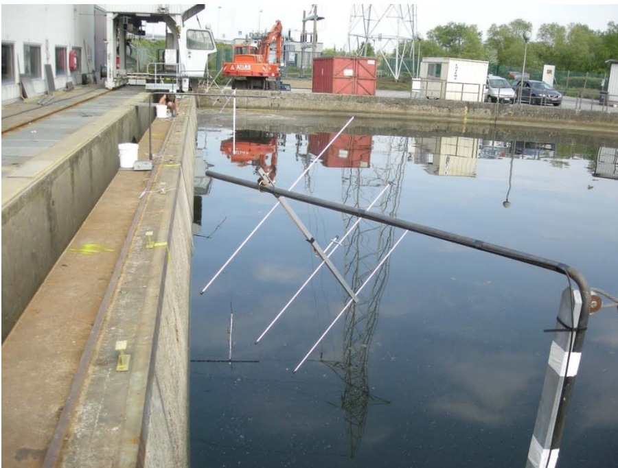
Abbildung 40: Stationäre Yagi-Antenne im Anströmbereich einer Wasserkraftanlage (Foto: Profish Technology)
