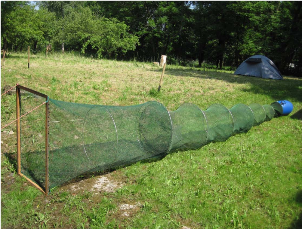
Abbildung 20: Netzreuse zur Erfassung des Fischabstieges über eine Fischaufstiegsanlage mit Weithalsfass am Ende zur Reduktion von Turbulenzen, sowie zur einfachen Leerung und Reinigung (Foto: F. Wagner)
