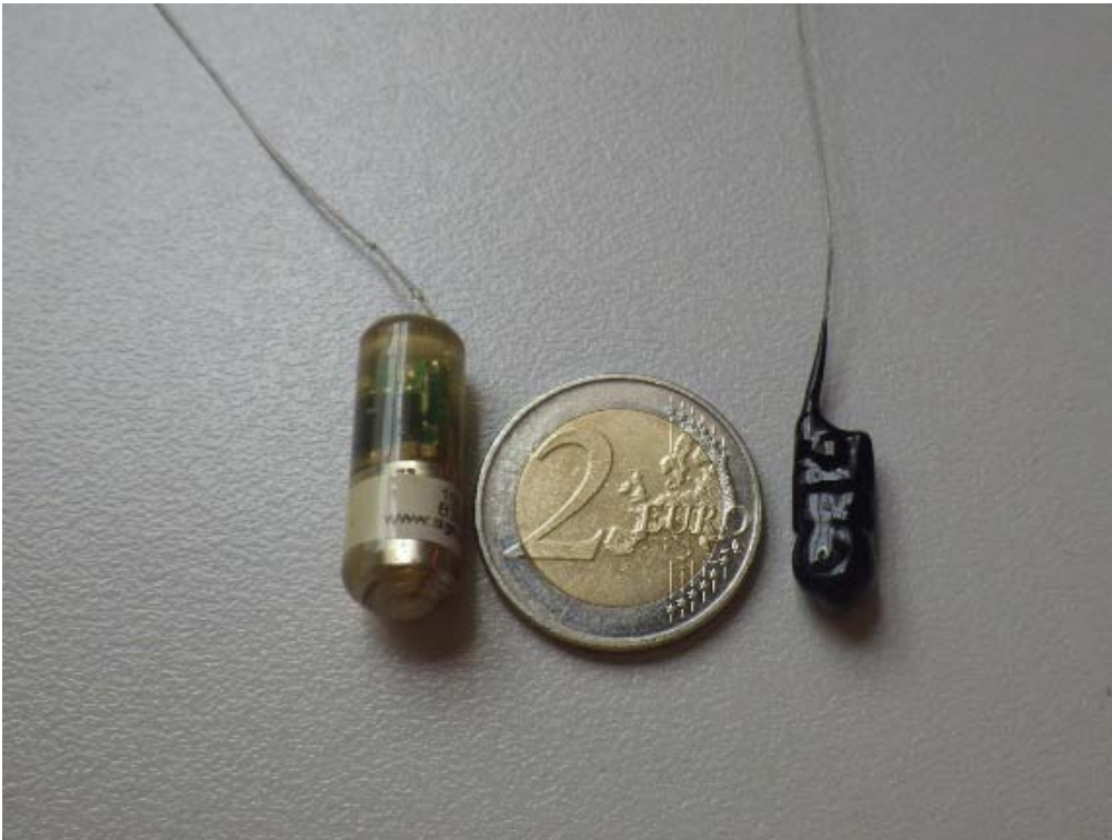
Abbildung 38: Vergleichende Darstellung zweier Radiosender der Firma Sigma Eight Inc., Kanada; das Gewicht des linken Senders beträgt 3,0 g, das des rechten Senders 0,8 g (Foto: Profish Technology)
