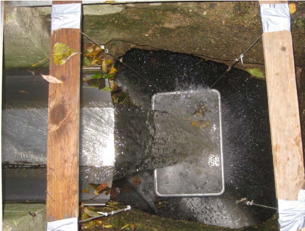
Abbildung 58: Lochkiste zum Auffangen des Rechengutes, um es anschließend auf enthaltene Fische zu untersuchen (Foto: W. Schmalz)
