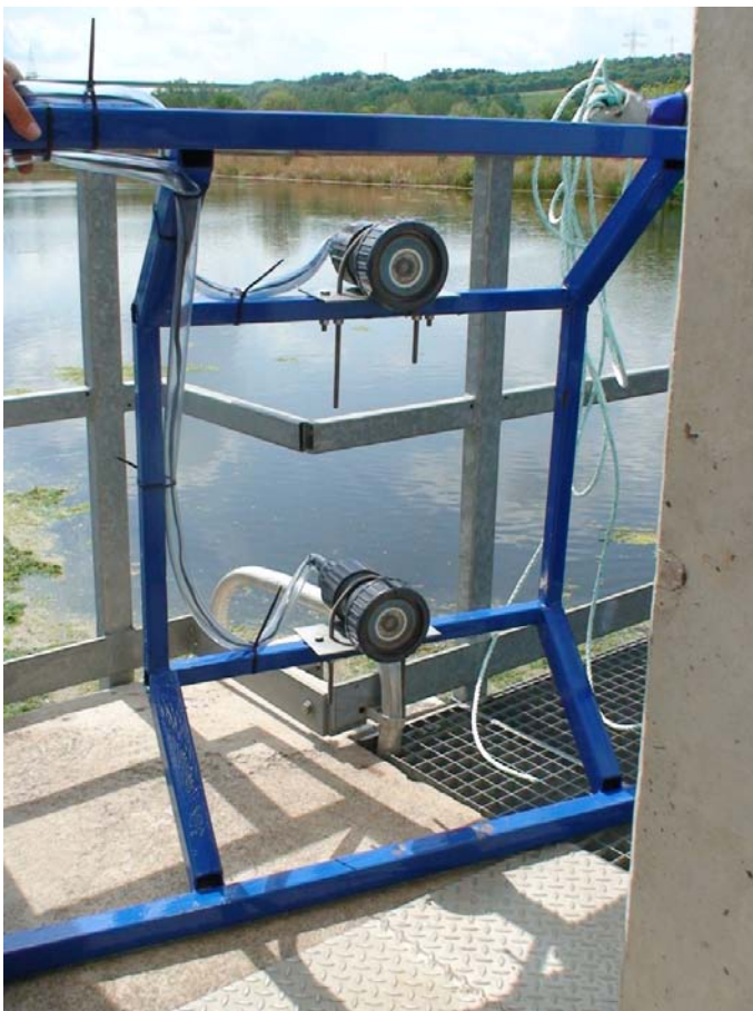
Abbildung 31: Zwei mit zusätzlichen Gehäusen abgedichtete Kameras an einem Gestell zur Überwachung einer größeren Passageöffnung (Foto: M. Schmalz)
