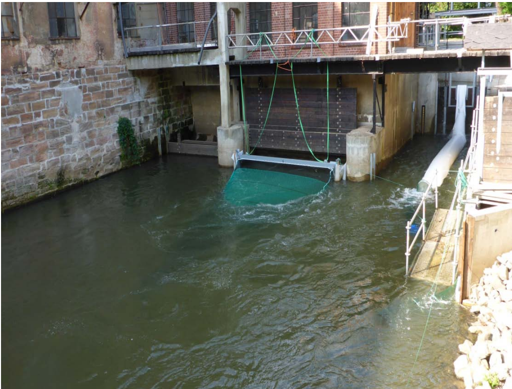
Abbildung 19: Hamen unterhalb einer Wasserkraftanlage in der Weißen Elster bei Leipzig (Foto: F. Wagner)
