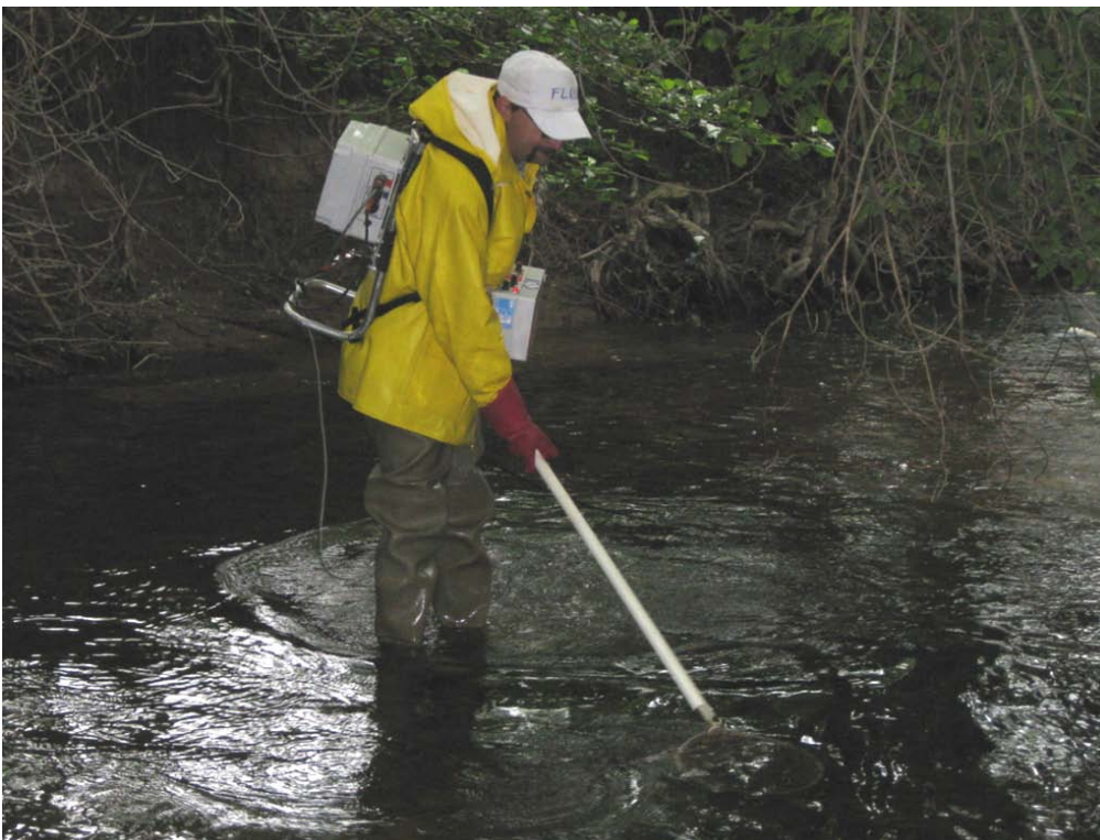
Abbildung 56: Watbefischung mit batteriebetriebenen Elektrofischereigerät (Foto: M. Schmalz)
