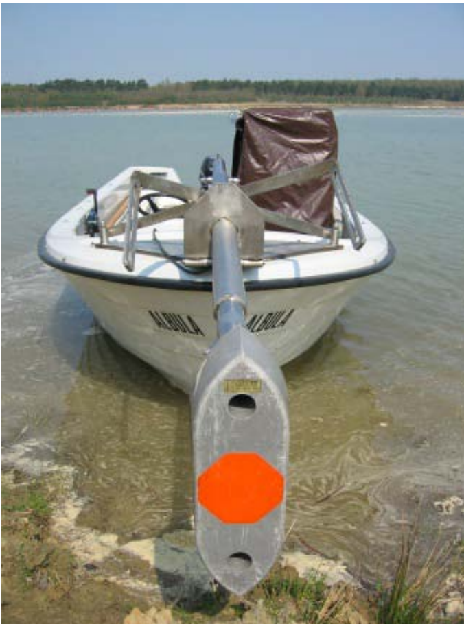
Abbildung 24: 120 kHz Split-Beam Schallgeber (Transducer) montiert an einem Boot (Foto: M. Schmidt)
