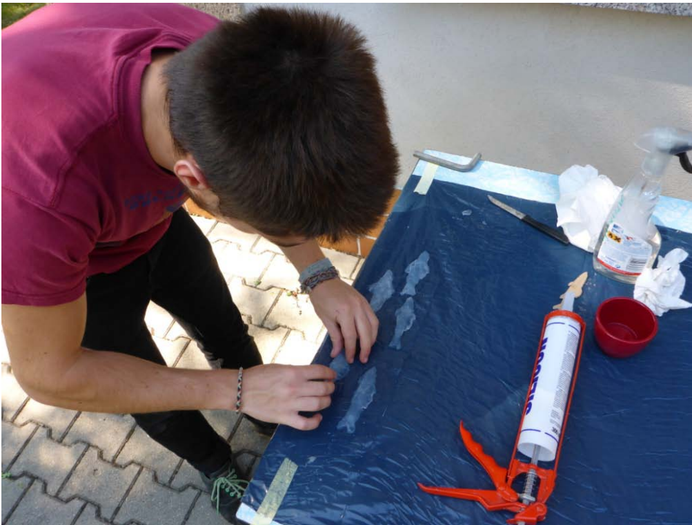
Abbildung 55: Herstellung von Silikonfischen zur Überprüfung der Fängigkeit eines Hamens hinsichtlich toter Fische (Foto: F. Wagner)
