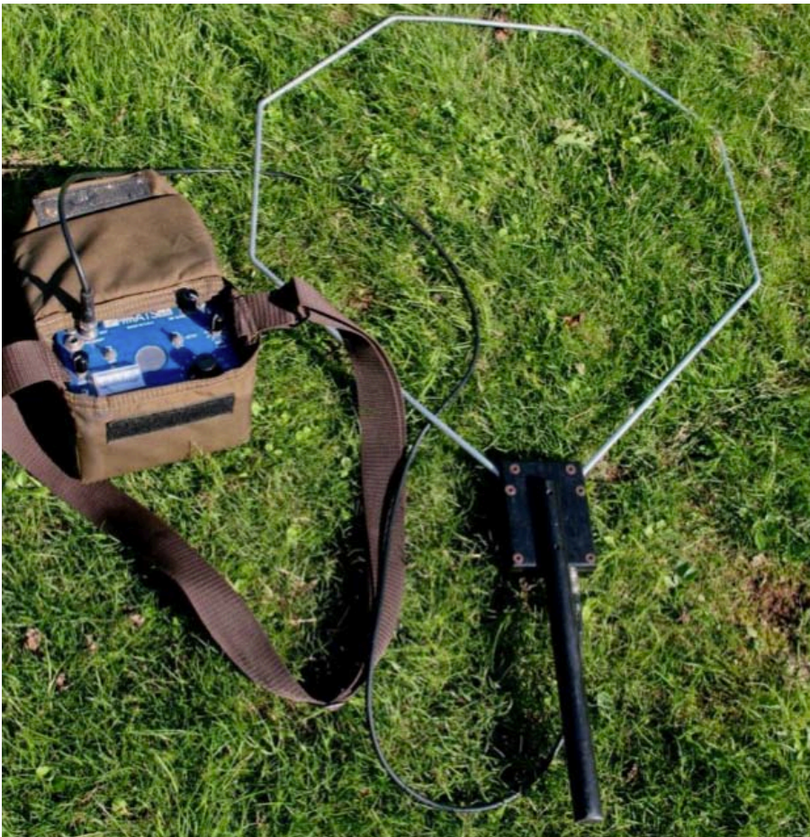
Abbildung 39: Tragbarer Empfänger für Radiosignale mit manueller Richtantenne (Foto: M. Ovido)
