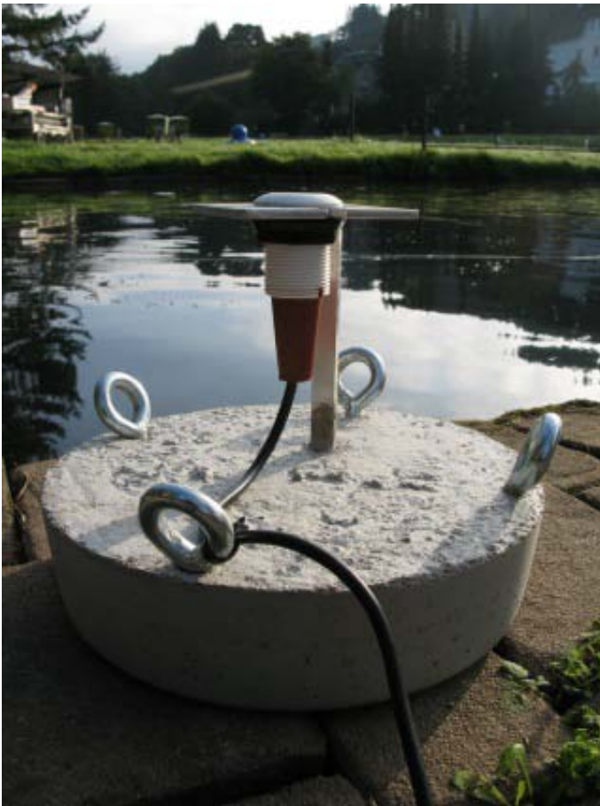
Abbildung 23: 200 kHz Single-Beam Schallgeber für die Bottom-Up-Detektion (Foto: M. Schmidt).
