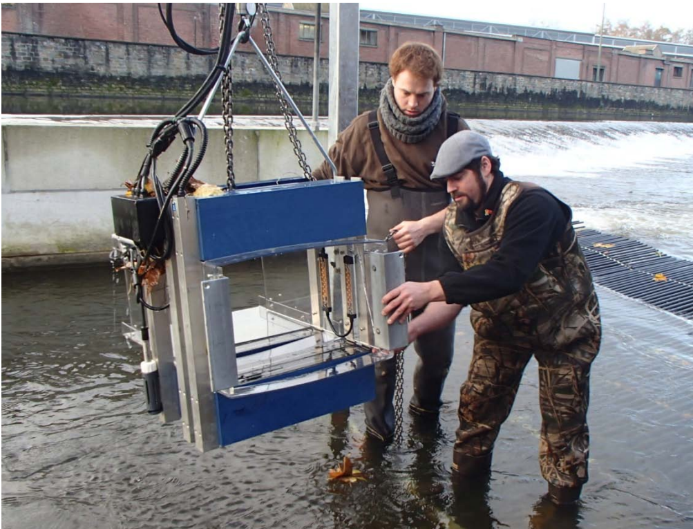
Abbildung 34: IchtyoS™ Laserfischzählssystem bei der Installation in einer naturnahen Fischaufstiegsanlage in Belgien (Foto: WSP, Canada & Profish Technology)
