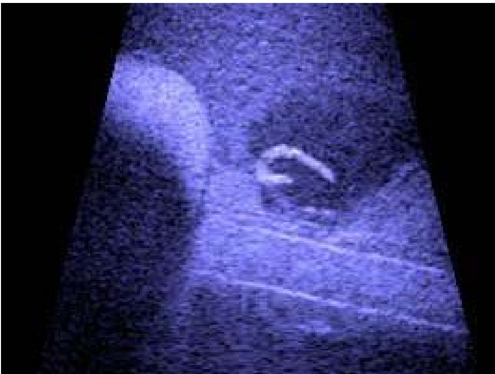
Abbildung 30: DIDSON-Standbild mit einem Aal kurz vor der Passage eines grundnahen Bypass-Systems. (Foto: M. Schmidt)
