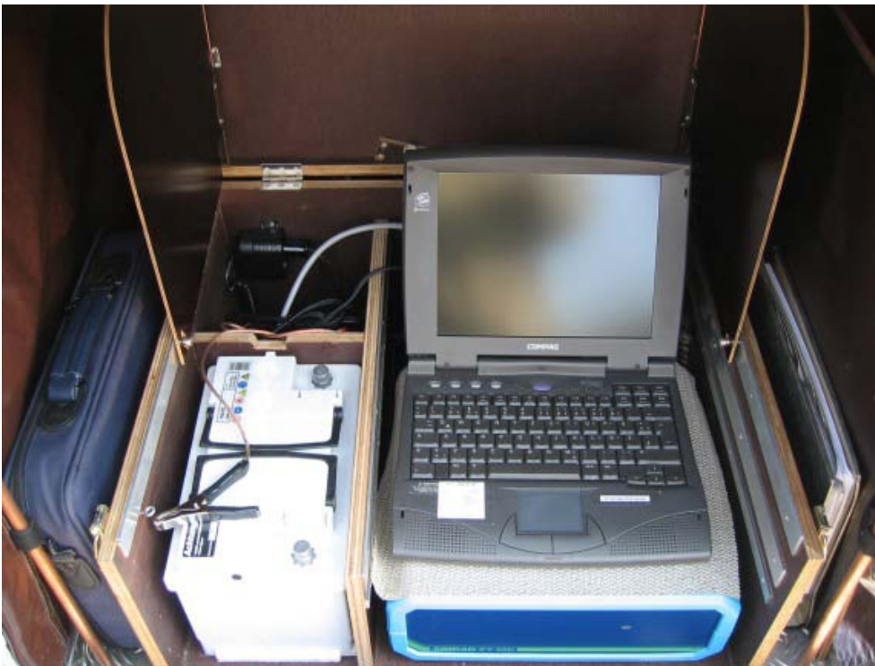
Abbildung 25: Simrad EY500 Split-Beam-Transceiver mit PC-Notebook (Foto: M. Schmidt)
