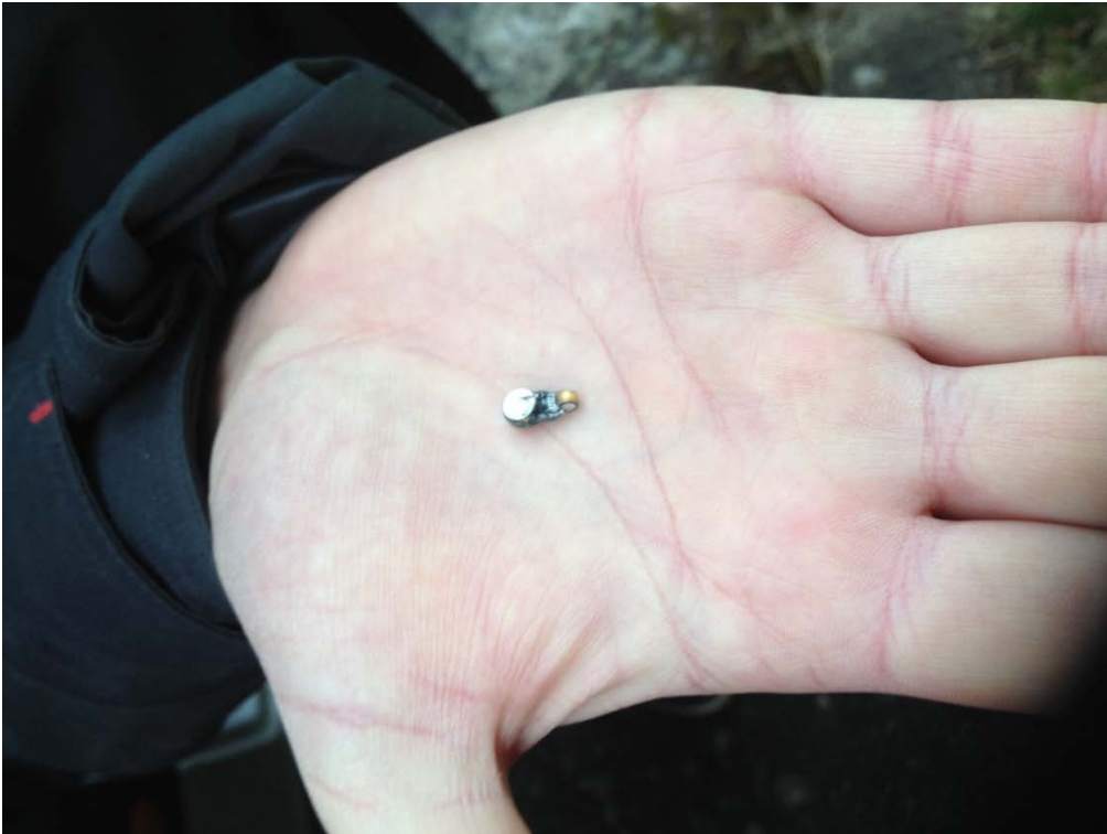
Abbildung 43: Acoustic-Tag, Juvenile-Salmon-Acoustic-Tag der Firma Lotek Wireless Inc. (Foto: E. De Oliveira)
