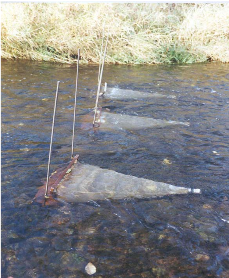
Abbildung 22: Driftnetze in einem Fließgewässer (Foto: F. Wagner)
