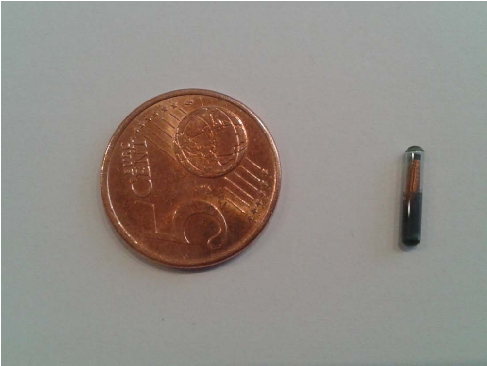
Abbildung 44: HDX-Tag der Firma Biomark Inc. (USA), Größenvergleich zu einem 5 Eurocent-Stück (Foto: Profish Technology)
