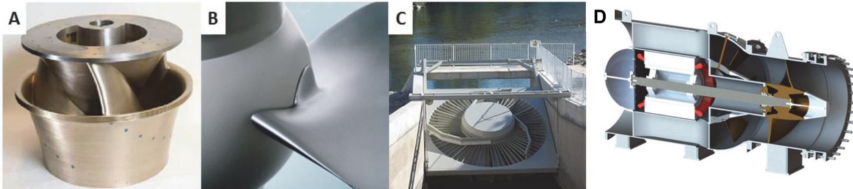
Modell einer Alden-Turbine (A), Naben-Ansicht einer Minimum gap runners MGR (B), VLH-Turbine in Servicestellung ( C), Schnittbild Nijhuis-Turbine (D)(HOGAN et al. 2014; KABLE INTELLIGENCE LIMITED 2017; VOITH GMBH 2017, PENTAIR 2017)
