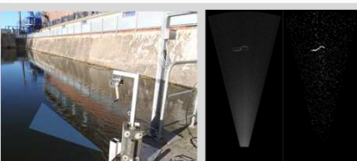
Sonarsetup am Standort (oben links) und Standbilder aus D-BOT Software (oben rechts): Originalvideo und zugehöriges gefiltertes Binärbild.
