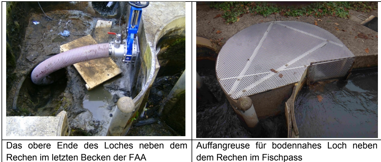
Abbildung 6: Fanggeräte der Abwanderungskorridore und deren Kontrolle.
