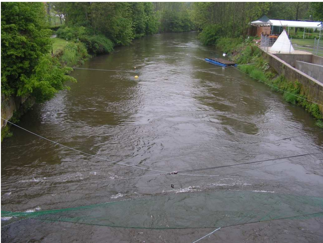
Foto 44: aufgespannter Hamen unterhalb der Turbine, Blick nach flussab
