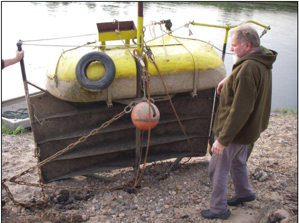
Abb. 11: Scherbrett des Hamens des Fischereibetriebs Gebr. Dobberschütz
