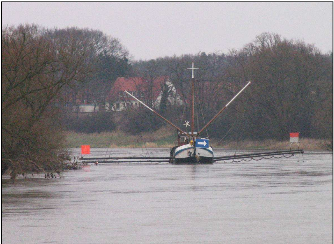
Abb. 5: Schokker des Fischereibetriebs der Gebrüder Dobberschütz, in Ruhestellung mit angehobenem Unterbaum (Ansicht in Fließrichtung)
