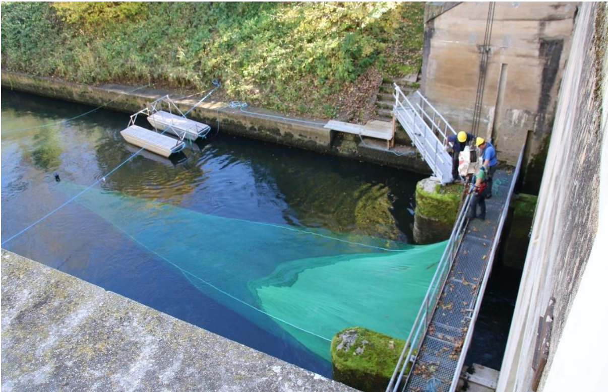
Abbildung 36: Installierter Hamen hinter der rechten Hauptturbine im Krafthaus während Kampagne 4
