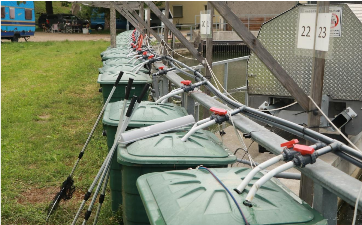
Abbildung 18: Nummerierte Kunststoffbecken der Hälterungsanlage mit Frischwasserzulauf und Frischluftversorgung
