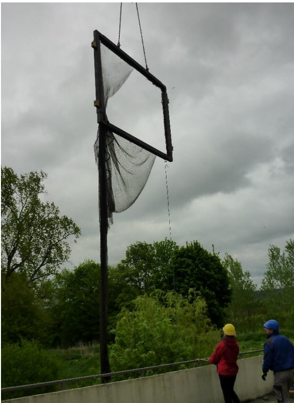
Abbildung 37: Bergung des zerstörten Hamens der Hauptturbine während der ersten Untersuchungskampagne
