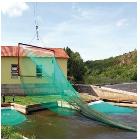
Abb. 16: Untersuchungen zur biologischen Wirksamkeit von Fischschutz- und Fischabstiegssystemen erfolgen oftmals mit netzartigen Fanggeräten, die in den Austrittsprofilen der Saugrohre (links) sowie im Austrittsprofil des Bypasses (rechts) installiert werden. Fotos: G. Ebel
