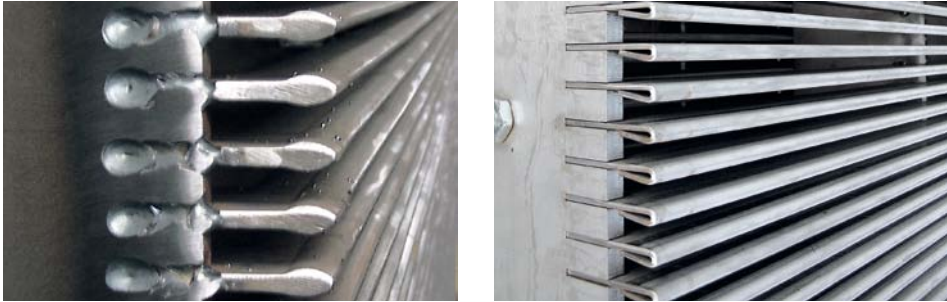
Abb. 11: Durch den Einsatz strömungsgünstiger Rechenprofile können auch bei kleiner Stabweite geringe Rechenverluste gewährleistet werden. Links: Profile vom Typ Einsal mit 10 mm lichter Stabweite, rechts: Profile vom Typ Oppermann mit 10 mm lichter Stabweite Fotos: M. Kehl
