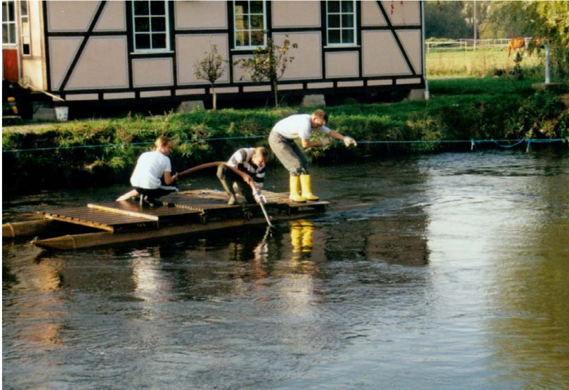
Foto 27: Reinigungsversuch mit durch B-Pumpe erzeugtem Wasserstrahl
