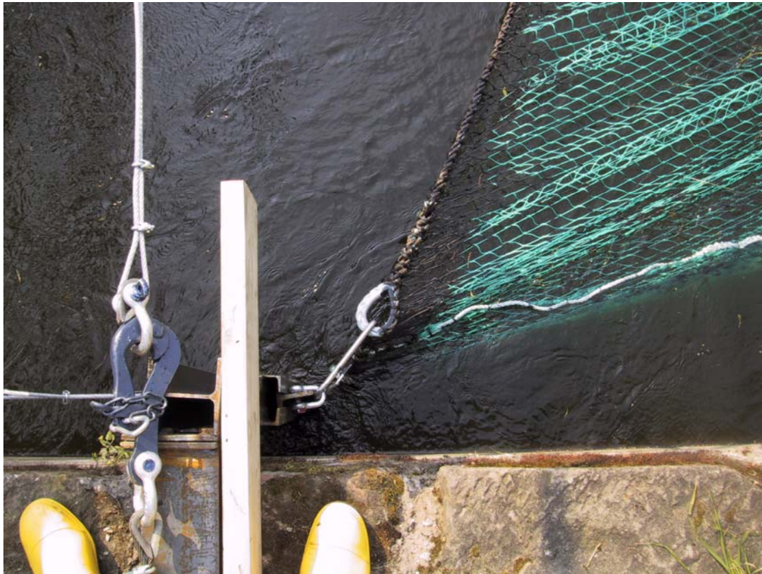
Foto 3: Rechter Stahlträger mit angeschweißter Führungsschiene und eingesetztem T-Profil; daran Stahldreieck des Hamens mittels Fischereischäkel befestigt; links im Bild der blaue Sliphaken, um eine schnelle Trennung der Stahlseile zwischen Seilwinde und Hamen zu ermöglichen.
