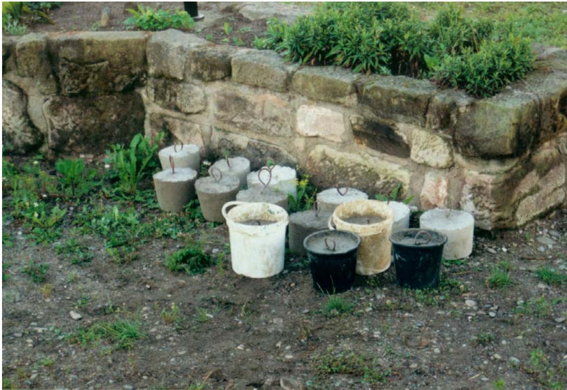
Foto 39: Betongewichte zum Absenken des Wehrfußnetzes
